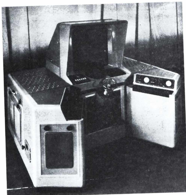
Félautomata buborékkamra felvétel kiértékelő (1959)
